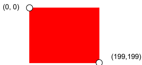
图 4-4：使用 Solid Fill 功能将[(0, 0) 到(199,199)]用红色填满
