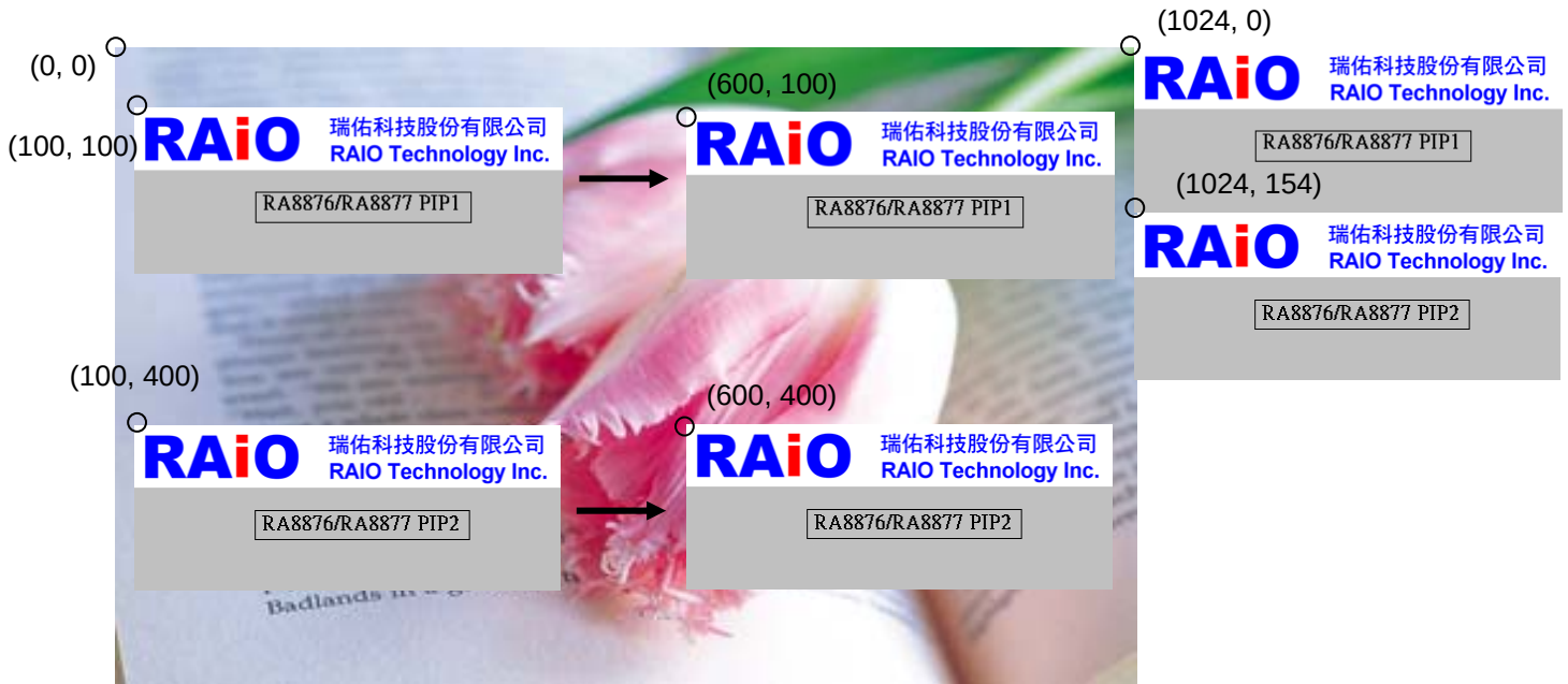
圖 5-5：改變 PIP Window 的起始位置來改變兩個 PIP Window 的顯示位置。
